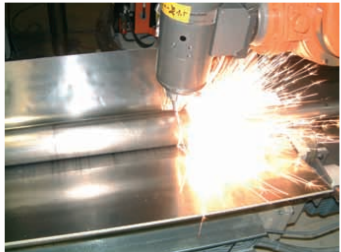
Schneiden von Titan-Rohren für Airbus
