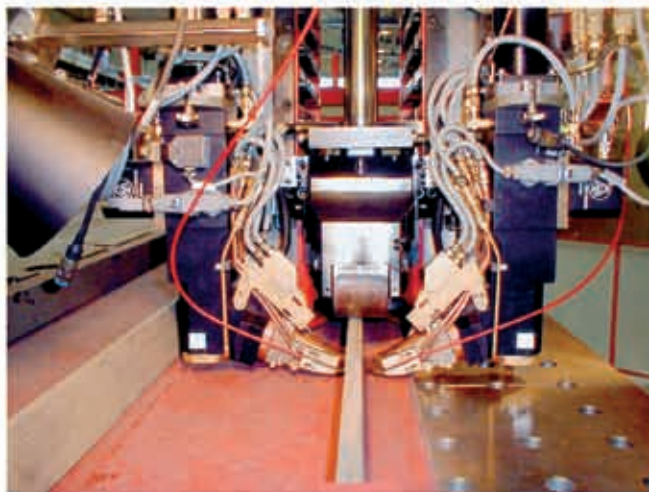
T-継手溶接
