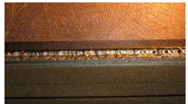
Schweißnaht, ausgeführt mit der EBO Jump-Technik
