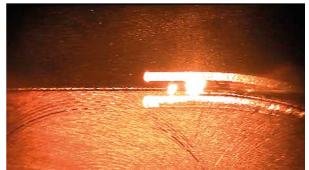
Gleichzeitige EB-Bearbeitung mit Vorwärmen, Schweißen und Kosmetiknaht
